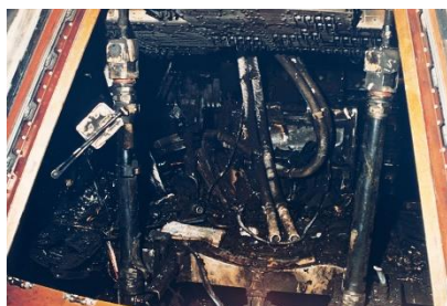
Fot. 12. Spalone doszczętnie wnętrze modułu dowodzenia misji Apollo 1
