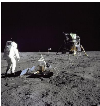
Fot. 10. Księżycowy eksperyment sejsmiczny, w tle lądownik Eagle
