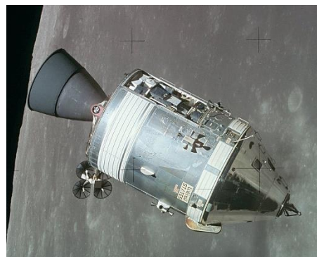
Fot. 5. Moduł serwisowy programu Apollo
