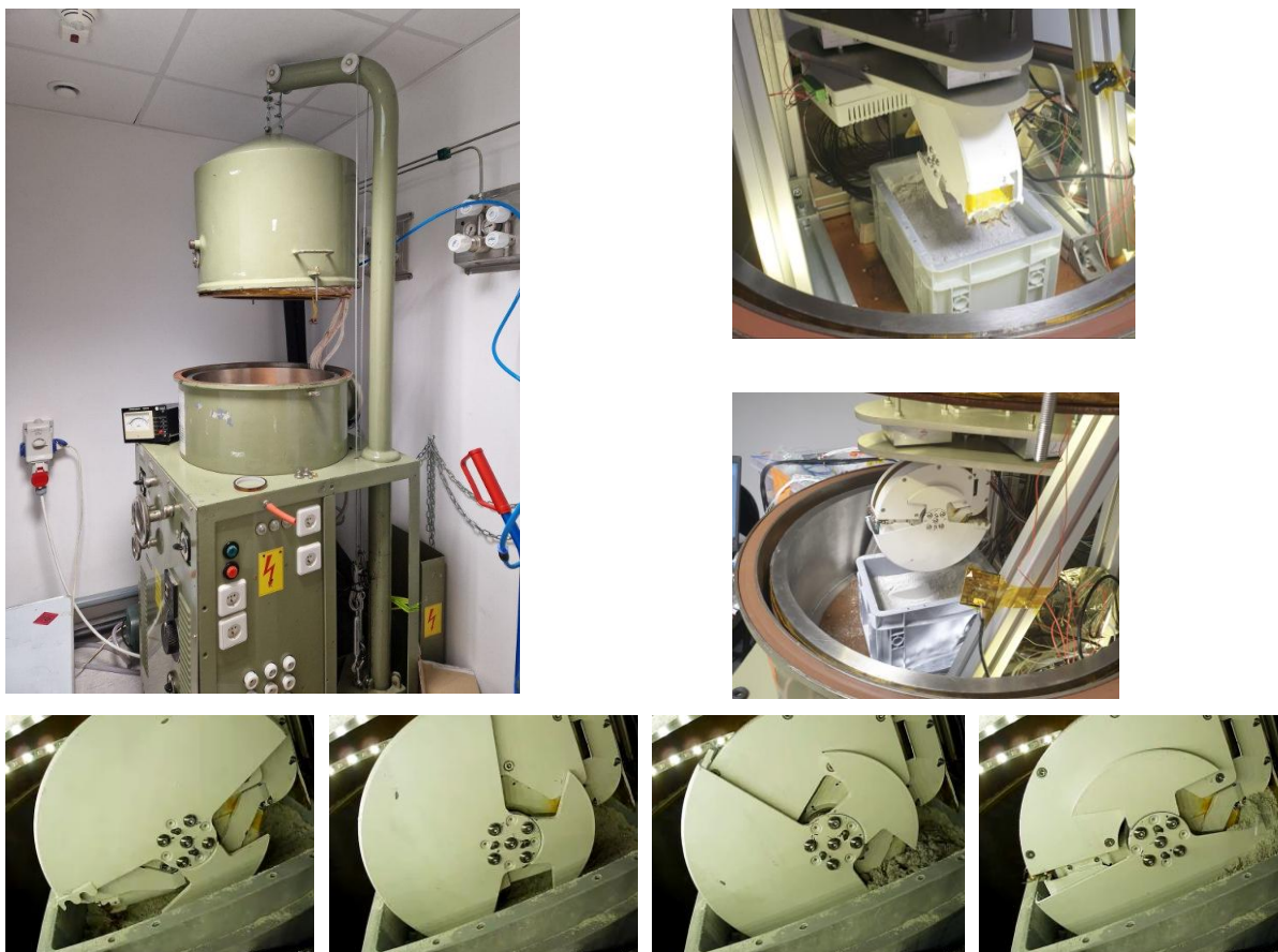
Rysunek 9 Zdjęcia DTVAC (po lewej) z RCE przed (prawy górny bok) i po (prawej) pojedynczym regolitem. W dolnym wierszu przedstawiono cztery zdjęcia z procesu kopania.
