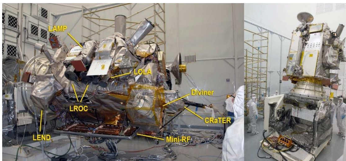
Rys. 4a Zestaw instrumentów LRO (po lewej) i LRO przechylane na stole testowym (po prawej) [29]
