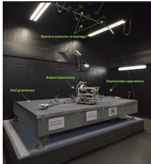
Rysunek 7-6 iv. Stanowisko do symulowania mikrogravitacji z planarnym manipulatorem (CBK PAN)
