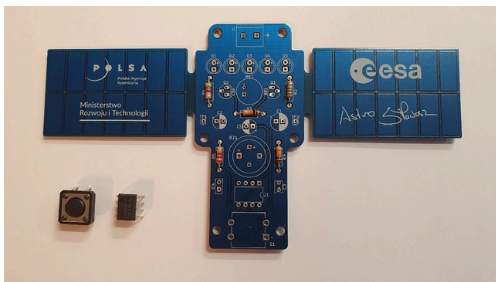
Ilustracja 7. Klucz do Kosmosu - przycisk i układ scalony
