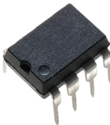
Ilustracja 8. Układ scalony - wcięcie
