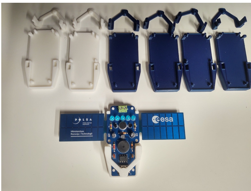
Rysunek 5. Nakładka 3D oraz zmontowany „Klucz do Kosmosu” w wersji szkolnej.
