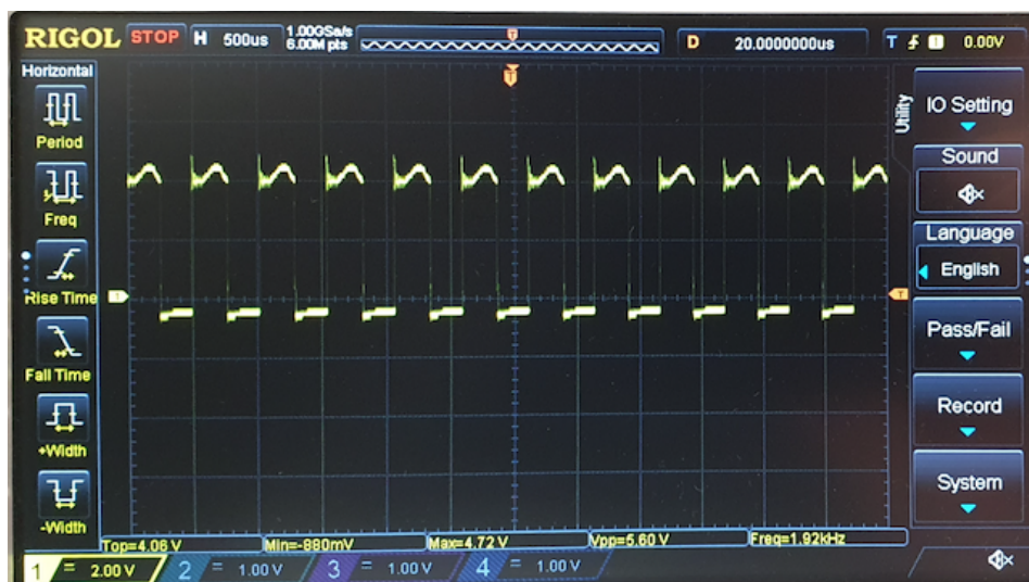
Rysunek 12: Rzeczywisty przebieg po zwiększeniu częstotliwości
